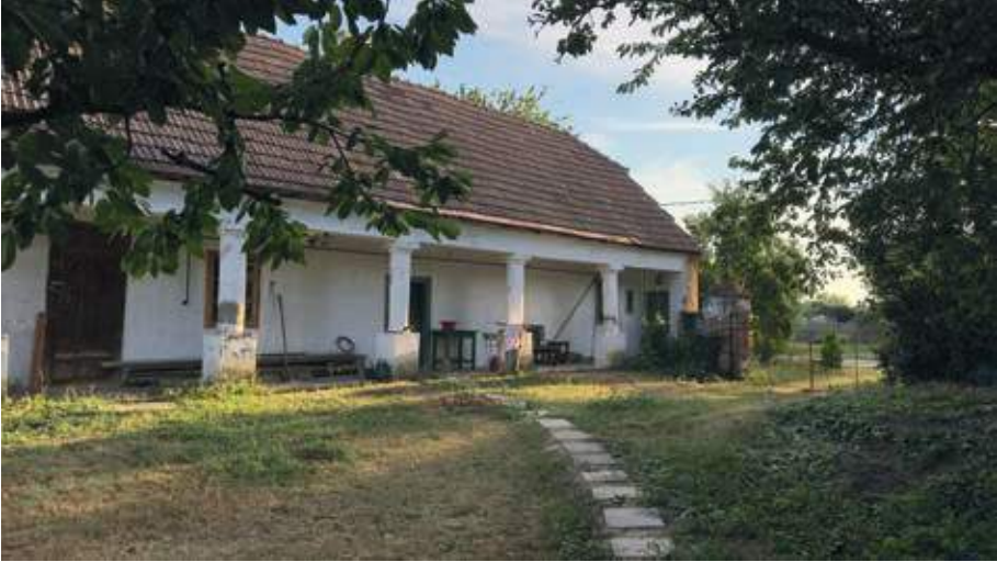
21. kép • Ez a tájolás a mai igényeknek is megfelelne. A keleti nap az utcai homlokzatot éri, majd a nap körbejárja az épületet. Az oszlopos tornác védi a falat a túlzott nyári felmelegedéstől és a csapóesőtől. Sárszentlőrinc, 2024
